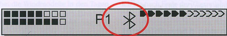
Die Bluetooth-Funktionalität des Balloninstrumentes wird im Gerätedisplay mit einem entsprechenden Symbol angezeigt (markiert)
