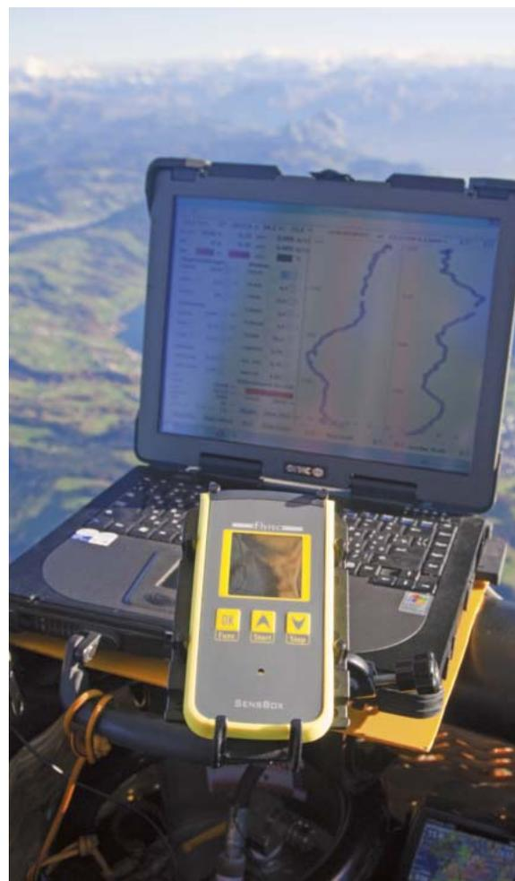
»SensBox« und Steuerungsrechner mit eigener Software zur Brennersteuerung während einer Fahrt im Voralpengebiet. Im rechten Teil auf dem PC-Display sind Richtung und Geschwindigkeit über die Höhe dargestellt. Damit ist es leicht, fahrtaktische Entscheidungen zu treffen und optimale Luftschichten anzufahren
